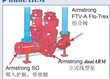
dualARM 立式线型在单入口和出口的一个泵壳内装入了两个泵。使得能用一组管道进行备用或并行运行。泵壳设计和端口阀允许将一个泵拆下进行检修,而另一个泵继续运行。当与吸入护板和Flo-Trex 阀一起安装时, dualARM 代表了当今 HVAC 商用市场中最长的使用寿命。
