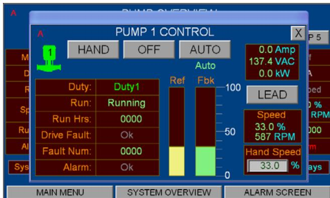
此屏幕用于控制泵、“手动”、“关”、“自动”、“引导”或“滞后”模式和手动速度
