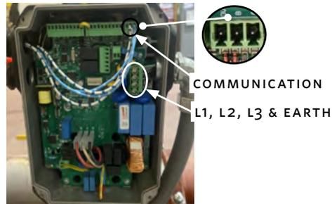
**FIGURE 4.20:** Wiring - iECM 71
