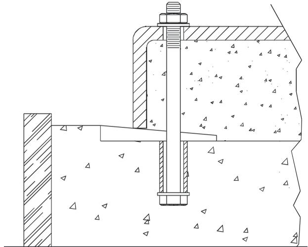
基础应该有足够的质量，吸收震动和在所有点上都永久支撑水泵底板。
